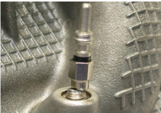
Bruch unterhalb des 6-kant
