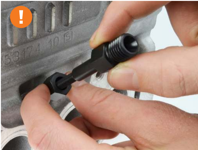
Einschraubführung beim Eindrehen festhalten.
