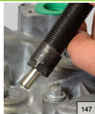
Injektorrest vollständig aus dem Zylinderkopf entfernt. Fertig!
