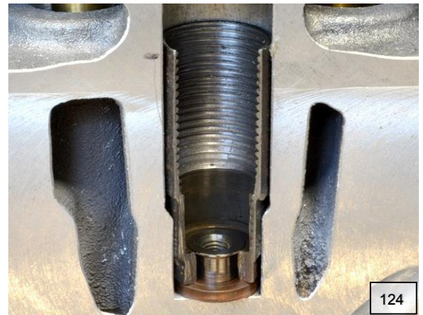
Zylinderkopf und Injektorrest im Schnitt
