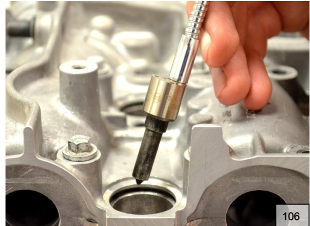
Düsenadelkörper vollständig aus dem Zylinderkopf entfernen
