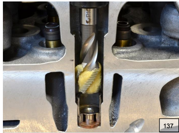
Zylinderkopf und Injektorrest im Schnitt
