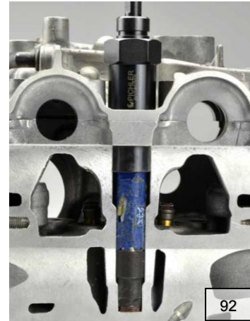
Zylinderkopf und Injektorrest im Schnitt
