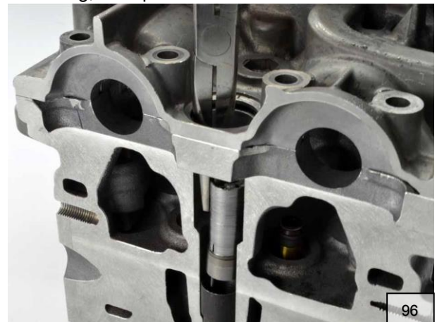
Zylinderkopf und Injektorrest im Schnitt
