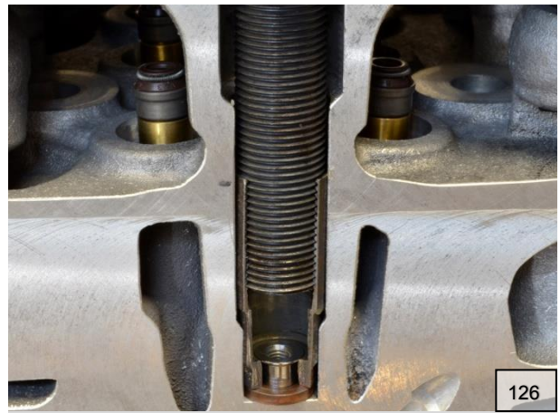
Zylinderkopf und Injektorrest im Schnitt
