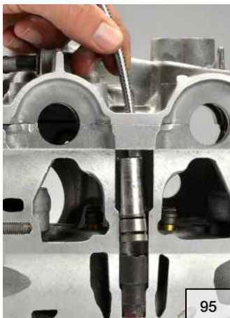
Zylinderkopf und Injektorrest im Schnitt
