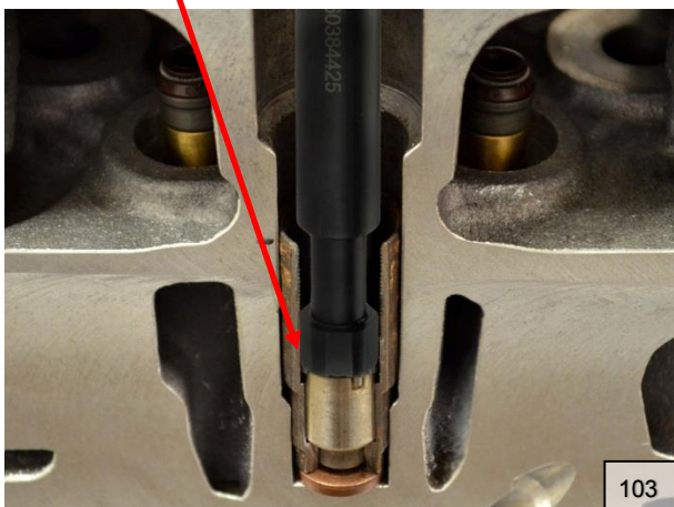
Zylinderkopf und Injektorrest im Schnitt
